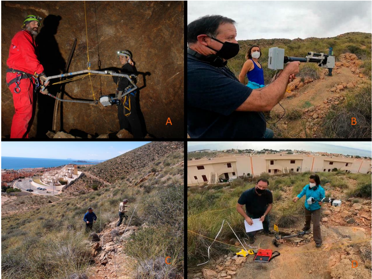
Localización de radiobalizas en superficie; A. Emisor pruebas en mina, B equipo receptor de señal. C y D triangulación de señal.
